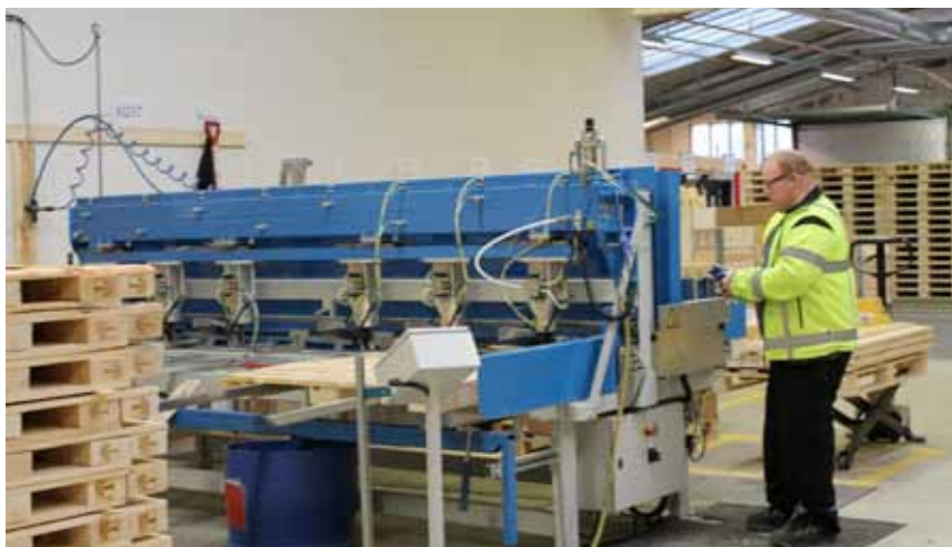
Spikring av palebein ble en flaskehals i 2013. Det nå løst med en ny automat. VTA-ansatt Harald Skretting legger i klosser i automaten.
