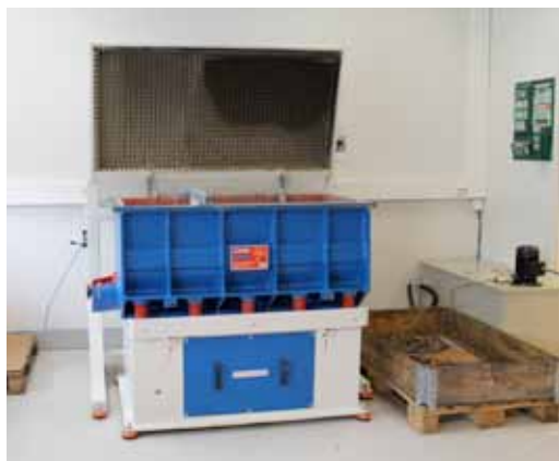
Vibrator som pusser av korrosjon og grader på delene.
