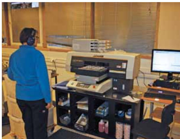
Trykking av logoer på refleksbrikker med ny teknologi ved hjelp av UV-printer.
