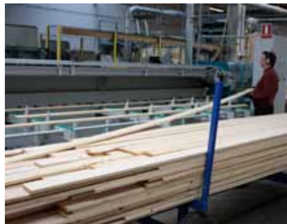
Det CNC-styrte kappanlegget på treavdelingen kapper hurtig og nøyaktig bordene som brukes i produksjonen.
