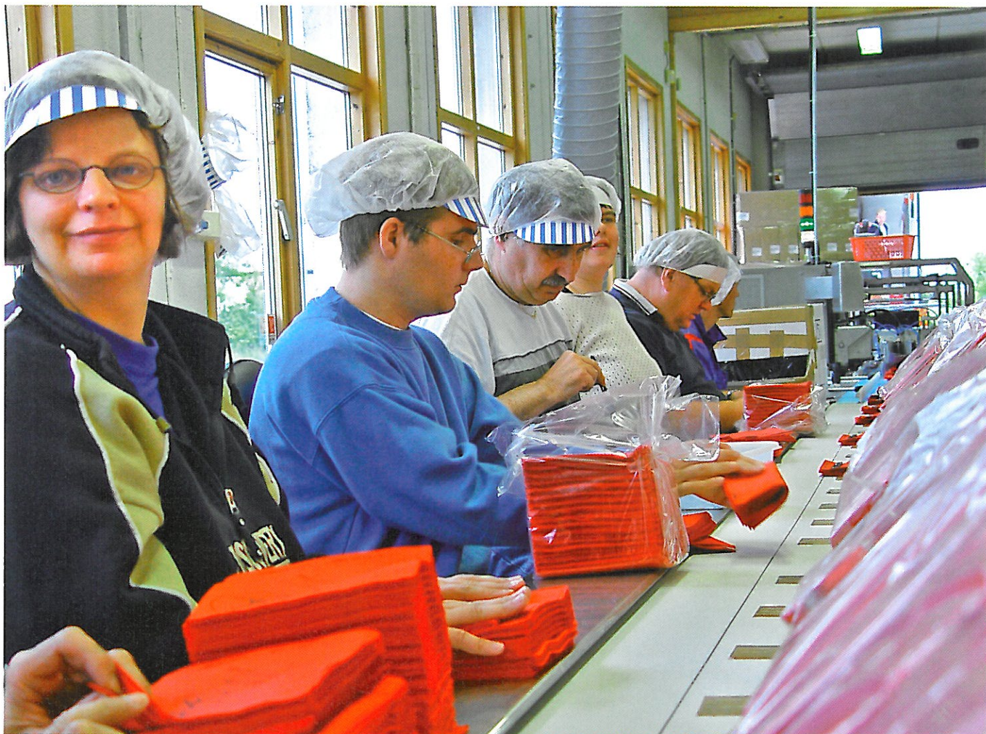
Pakking av bestikk og servietter til take-away. Pakkingen foregår på Flowpack pakkemaskin.
